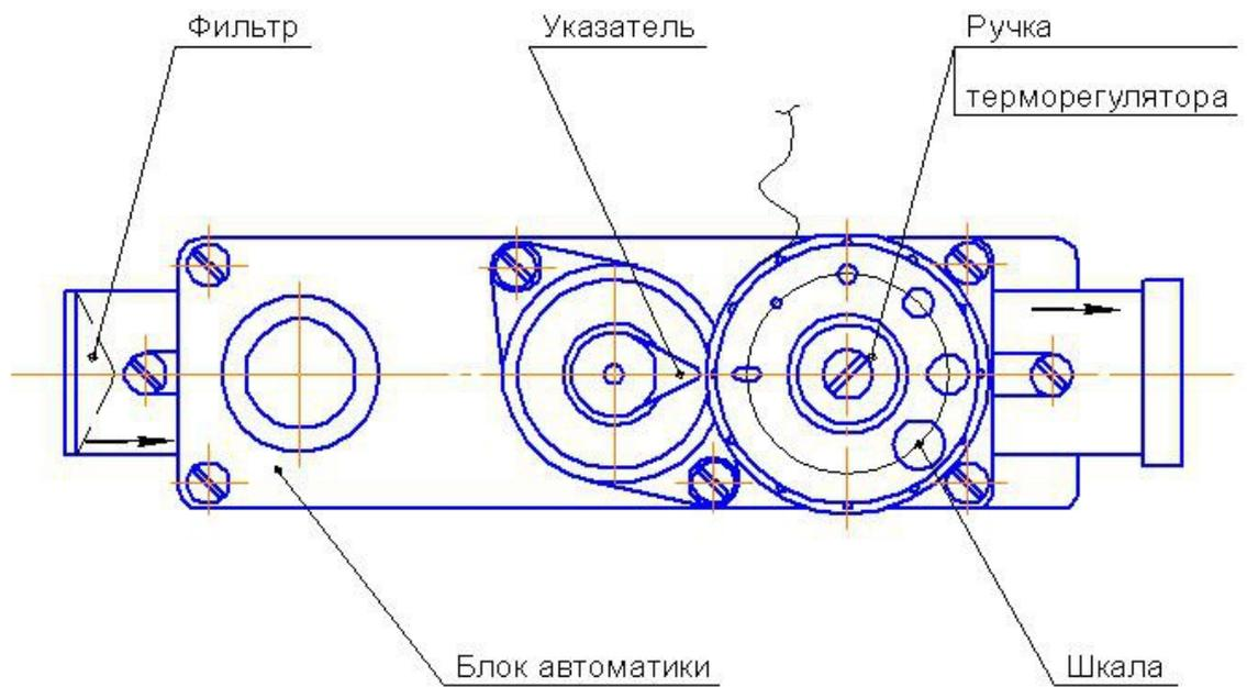
Рис.4 Ручка терморегулятора в положении "выключено".
