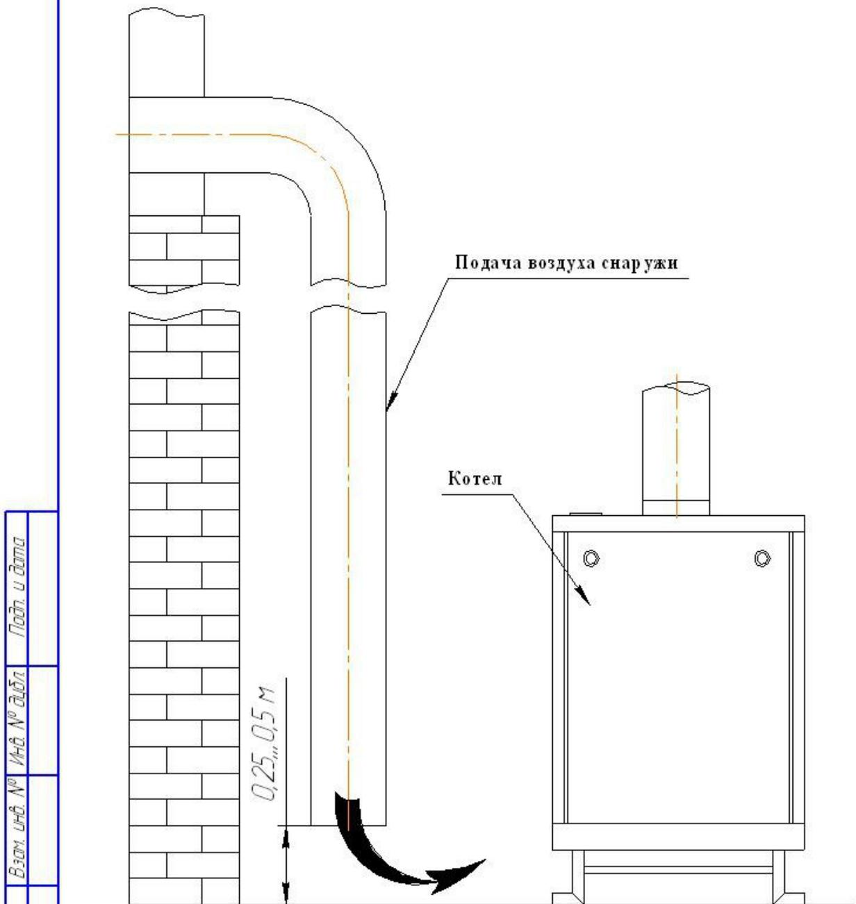
Рис. 8. Подача воздуха в герметично закрытое помещение.
