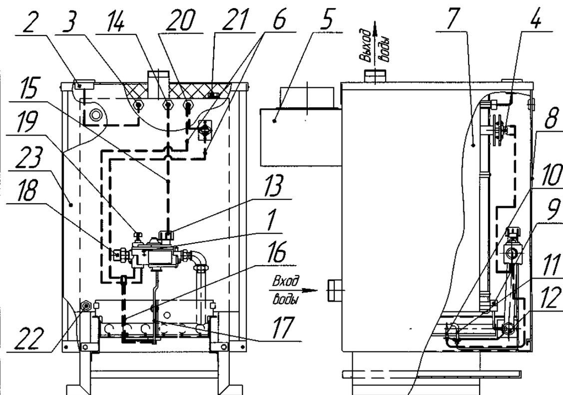
Рис. 2. Конструкция котла.
