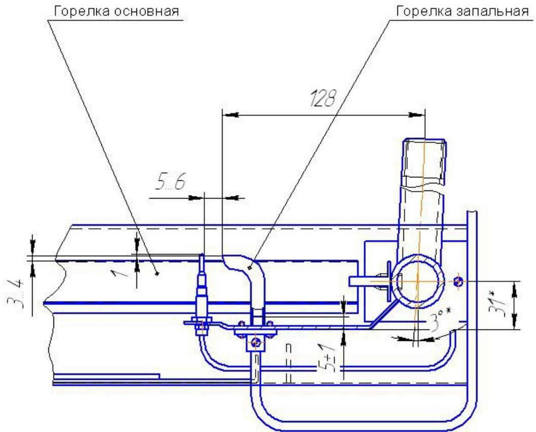
Рис.2А Схема расположения горелки запальной относительно основной.
